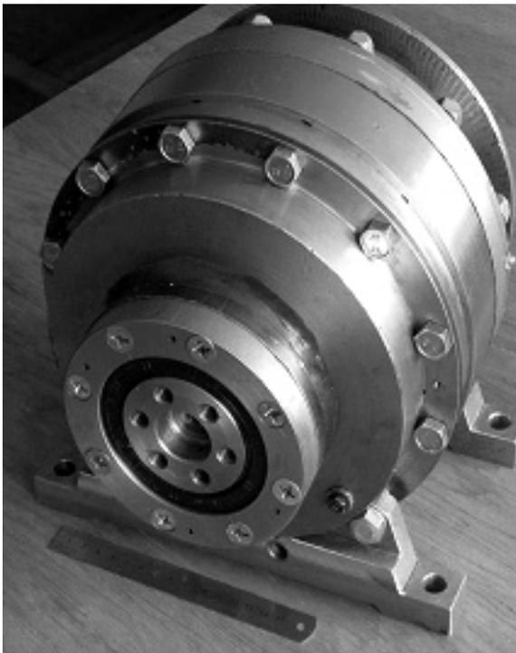
Рис. 1. Общий вид механического вариатора для мобильной техники
