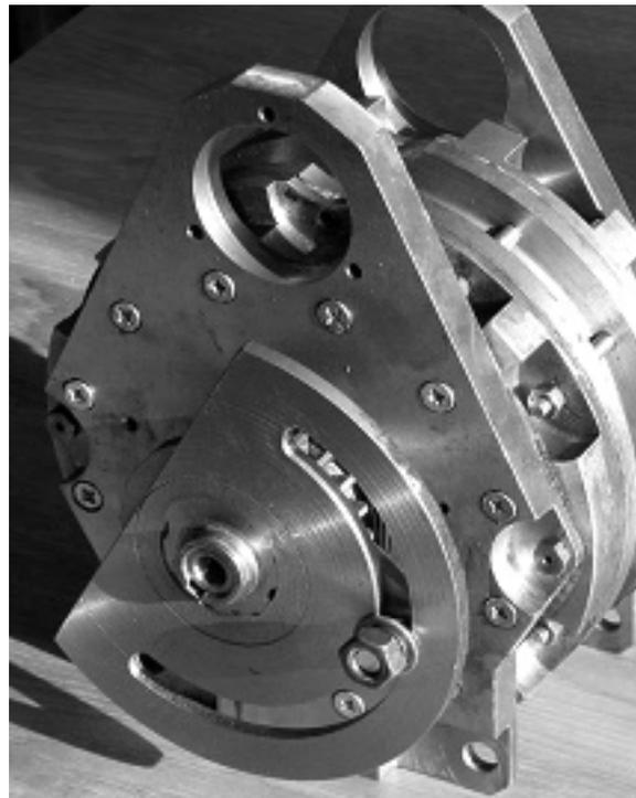
Рис. 1. Общий вид механического вариатора для регуляторов шага высева универсальных сеялок
